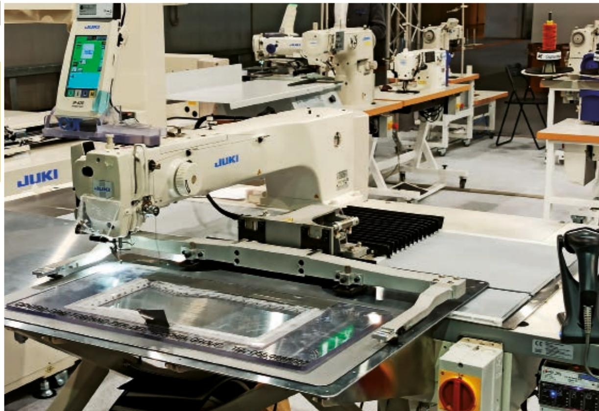
per svolgere intere sequenze di programmi di cucitura, senza bisogno di meccanico e cacciavite come una volta. Non solo: non è più necessario che chi cuce sia specializzato e cambi il programma, perché la macchina fa tutto da sola e si adegua al tipo di operazione in modo automatico, permettendo uniformità e qualità».
